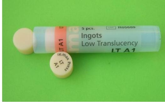
الشكل (23) مضغوطات خزف pressable نظام ITe-max الشكل (24) ملونات خارجية للخزف (Shade) e-maxCeram
