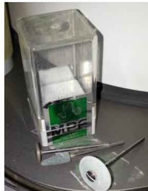
الشكل (19) سنابل ورووس خاصة بتشذيب الخزف الشكل (20) دليل تحديد لون الدعامات Natural Die Materiales
